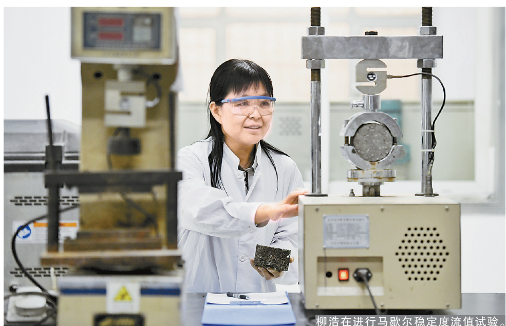
柳浩在进行马歇尔稳定度流值试验。
