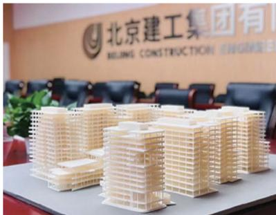
为更好让管理人员及施工作业人员了解本工程结构形式、重点难点及特殊部位节点，项目团队配置3D打印设备，历时一个月时间，绘制构件图纸100余张，将东地块各重点、难点及特殊部位构件转化为精确度极高的三维实体模型，实现重点部位“可视化”交底。
