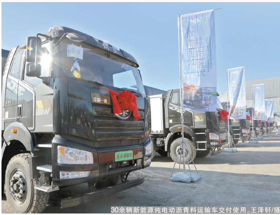
30余辆新能源纯电动沥青料运输车交付使用。王泽轩/摄
